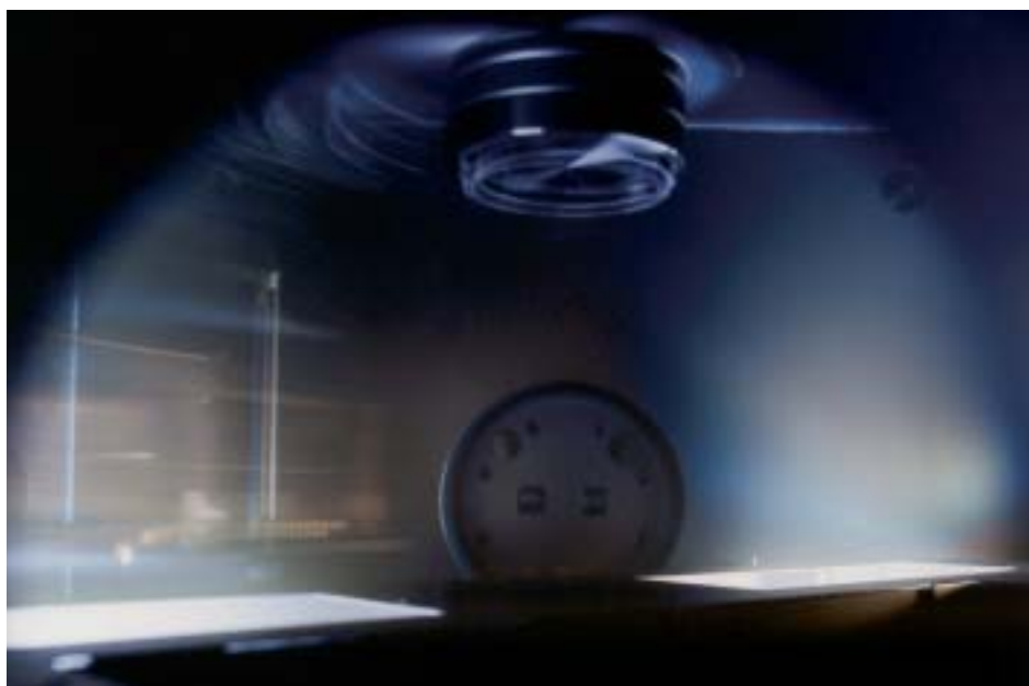
Abb. 1: Blick in die Beschichtungskammer mit zwei aktiven Magnetronsputterquellen der Targetmaterialien Molybdän (rechts) und Silizium (links). Über den Quellen bewegt sich das rotierende Substrat.
