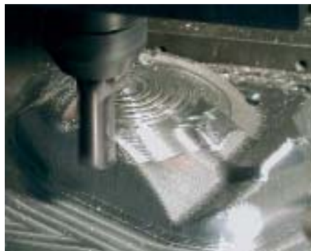
Abb. 3: Fräsbearbeitung eines Werkzeug-Rohlings
