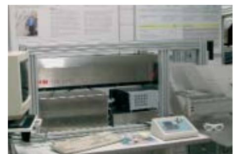
Abb. 3: CO 2 -Laserbearbeitungssystem mit x-y-Scanner und Planfeldoptik
