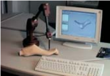
Abb. 1: Digitalisiersystem DCAMnc mit manuellem Tastarm (NCSoft Wagner, Schwerin)
