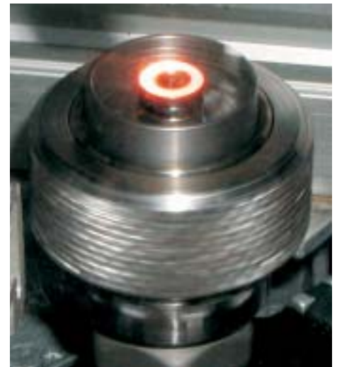
Abb. 1: Anlasszonenfreies Laserstrahlhärten einer verschleißbelasteten Kreisringfläche (Standhärting)
