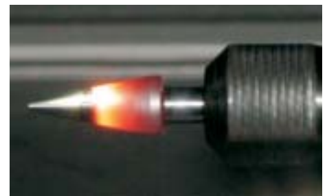
Abb. 2: Anlasszonenfreies Laserstrahlhärten an einem kegelförmigen Ventileinsatz für Hydraulikventile (Vorschubhärting)
