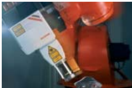
Härten der Greiferkurve einer Druckmaschine mit Hochleistungs-Diodenlaser
