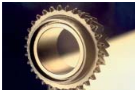
Laserstrahlschweißen eines Schaltrades für PKW-Handschatgetriebe, 16MnCr5 einsetzgehärtet
