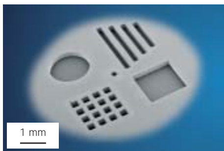
Abb. 1+2: Mittels diodengepumptem Festkörperlaser "GATOR UV" geschnittene Strukturen in Silizium-Wafern
