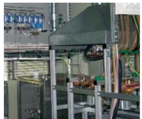
Abb. 4: ArcJet-CVD-Anlage zur quasi-kontinuierlichen Beschichtung (30 kW DC-Arc-Quelle)
