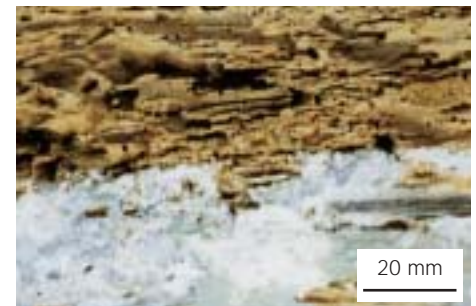
Abb. 1: Abtrag von Gips-, Schmutz- und Farbresten von einer stark geschädigten Holzoberfläche (oben gereinigt, unten Ausgangszustand)
