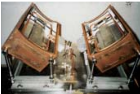
Abb. 2: Modul zur bogengestützten Plasmareinigung
