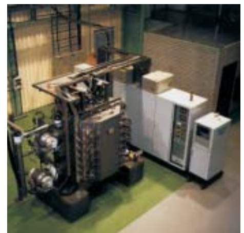
Laser-Arco® - die Technologie zur Abscheidung von Diamor®
