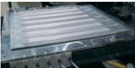
Abb. 3: Komplett geschweißtes Flugzeug-Testpanel
