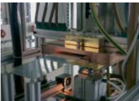
Arc-Jet-CVD-Reaktor während der Beschichtung von Edelstahl
