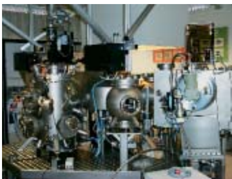
Abb. 3: UHV-Clustertool-Beschichtungsanlage mit PLD-Modul
