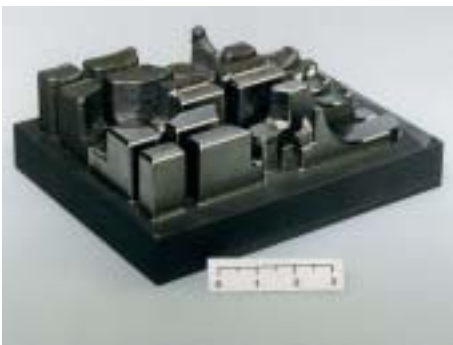
Abb. 3: Spritzguss-Formeneinsatz, lasergeneriert (hinten) und fertigbearbeitet (vorn)
