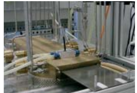
Abb. 3: Mikrowellen-AP-CVD-Anlage zur quasi-kontinuierlichen Beschichtung (6 kW-Quelle)
