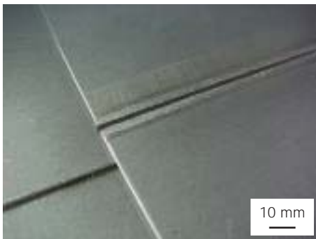
Abb. 2: Laserstrahlgeschweißte Stahlbleche TRIP RA/K 40/70, vor und nach der lokalen Wärmebehandlung
