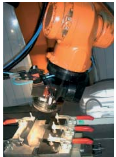
Abb. 4: Testschweißung an zwei Arbeitsebenen mit einer Vorschubbahn
