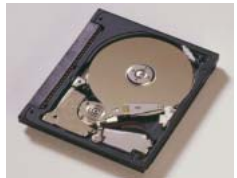
Abb. 2: IBM Microdrive, das kleinste derzeit im Handel befindliche Laufwerk, hat eine Kapazität von 1 GB, wiegt nur 16 g und ist nur 42,8 · 36,4 · 5 mm 3 groß. Seine Speicherdichte beträgt 15,2 Gbit in -2 .
