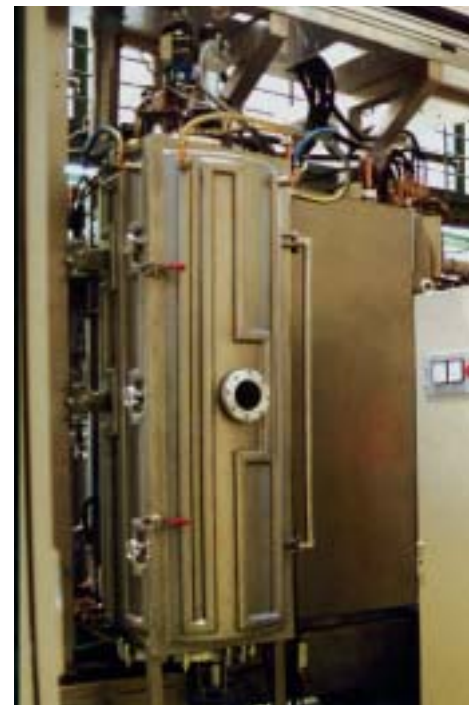
Abb. 4: PVD-Anlage MZR 373 mit installiertem Laser-Arc-Modul (Rückseite)
