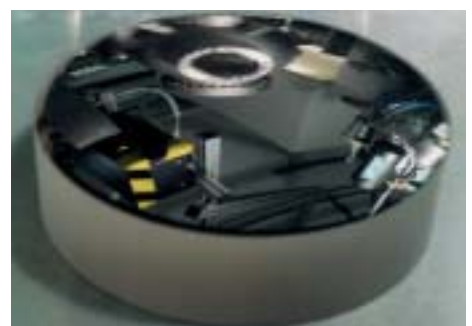
Sphärischer Spiegel, beschichtet mit einer Mo/Si-Multischicht
