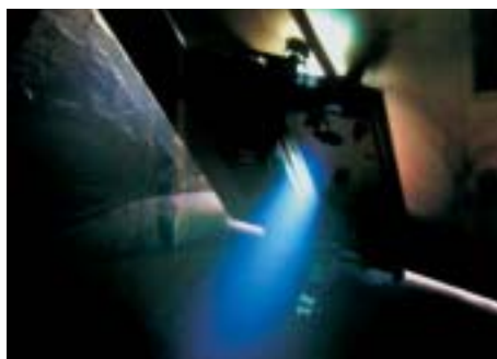
Arc-Beschichtung von temperaturempfindlichen Fasern
