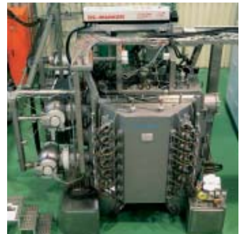
Abb. 3: PVD-Anlage MZR 373 der Firma Metaplas Ionon (Frontansicht)
