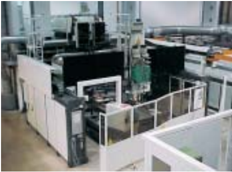
Abb. 1: Gantry-Laserschweißportal zum beidseitig gleichzeitigen Schweißen von Flugzeug-Panels
