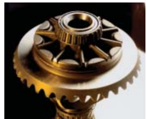
Abb. 2: Laserstrahlgelgeschweißtes Differentialgetriebe (Verbindung von einsetzgehärtetem Tellerrad mit gusseisernem Ausgleichsgetriebe)
