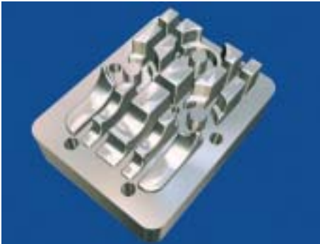
Abb. 2: CAD-Modell eines Spritzguss-Formeneinsatzes
