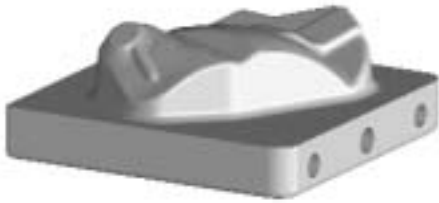
Abb. 1: 3D-CAD-Modell eines Prägewerkzeugs (Stempel)
